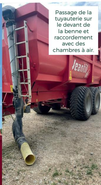
Passage de la tuyauterie sur le devant de la benne et raccordement avec des chambres à air.
