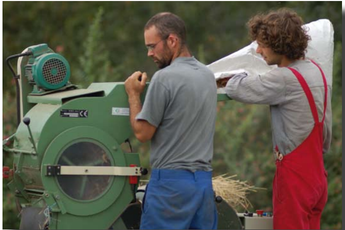
Batteuse à bottillons électrique, idéale pour battre des petites gerbes
